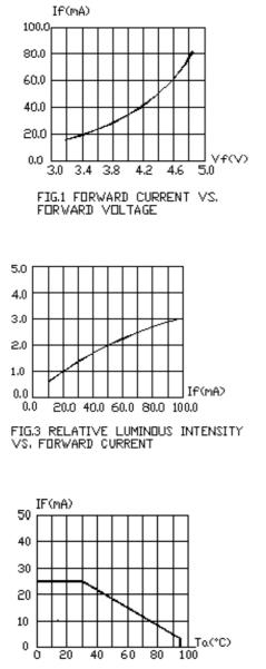
FIG.5 MAXIMUM FORWARD CURRENT VS. AMBIENT TEMPERATURE(T\_Mox=105°C)
